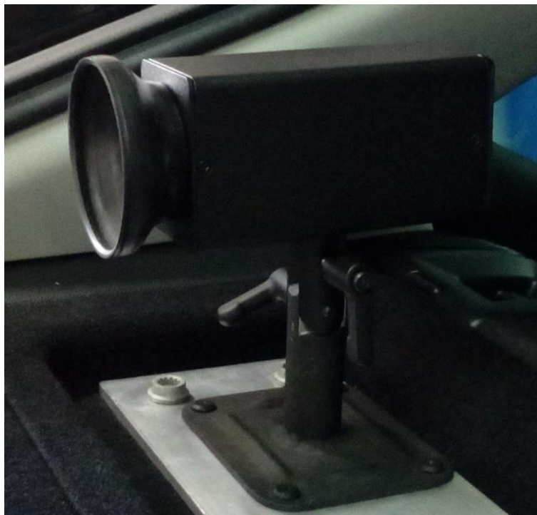
Rys. 3.6. Widok kamery tylnej zamontowanej na wsporniku.
